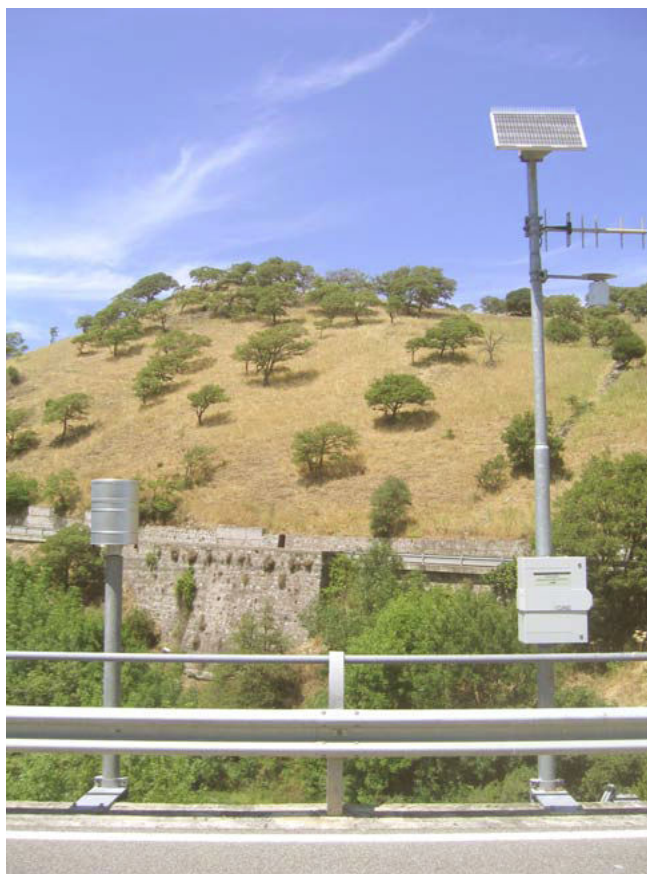
Figure 3, 4 e 5. Alcune vedute della stazione di Badu Crabolu. Sensori presenti: pluviometro, termometro e idrometro.
