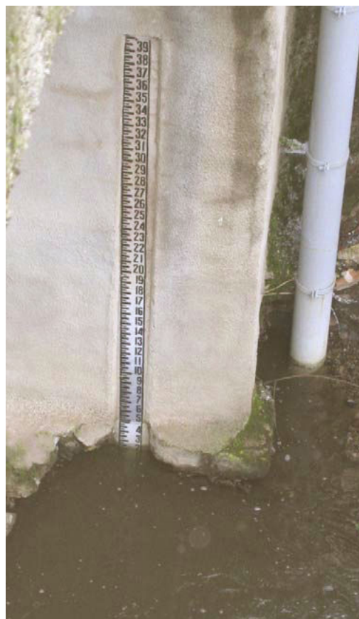
Figure 3, 4 e 5. Alcune vedute della stazione di Badu Crabolu. Sensori presenti: pluviometro, termometro e idrometro.
