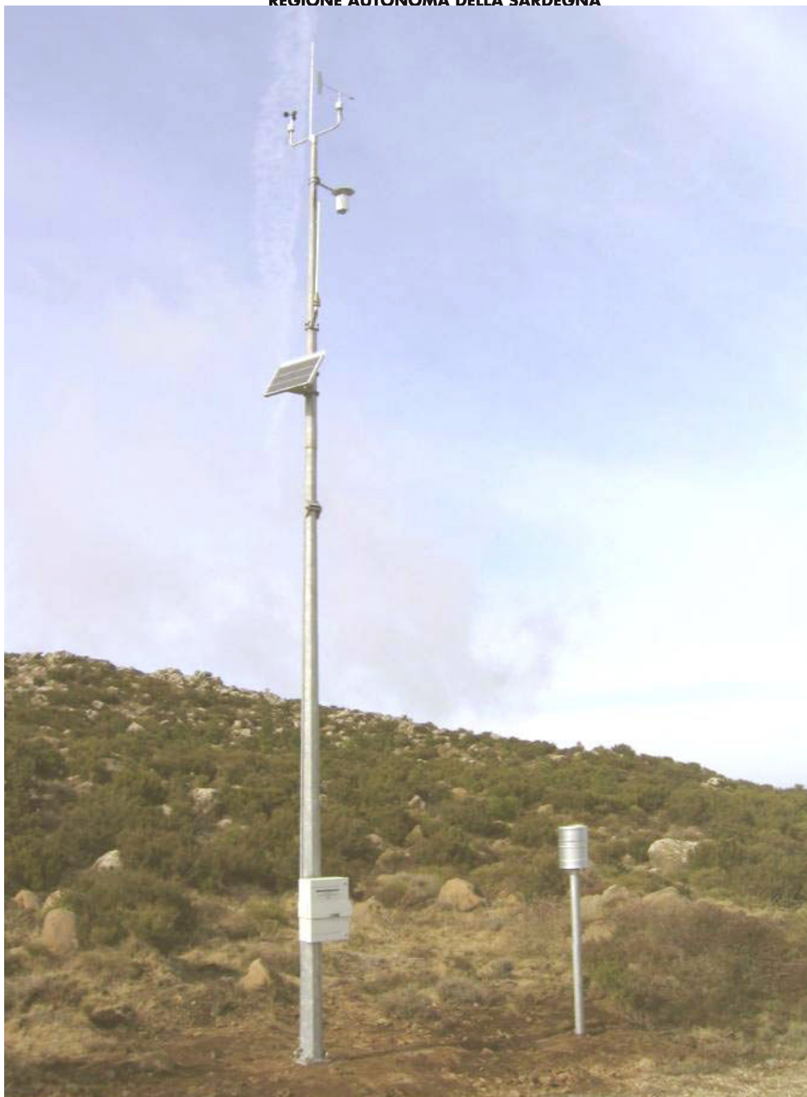
Figura 2. Stazione di Badde Urbara, sensori presenti: pluviometro, termometro, direzione e velocità del vento
