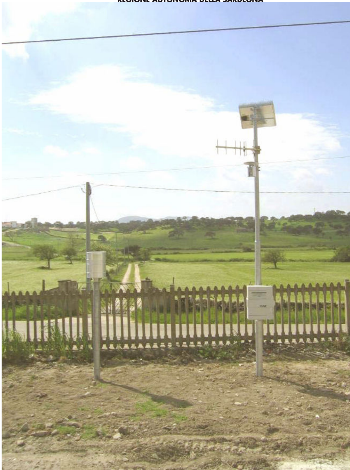
Figura 1. Stazione di Ardara, sensori presenti: pluviometro e termometro
