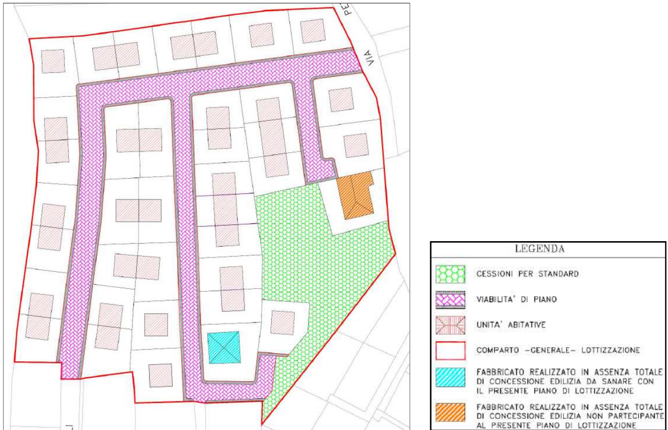
Figura 2 - Planimetria della lottizzazione – Stato Post Intervento
